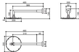
Vazão: 6 l/min com 10 m.c.a.
