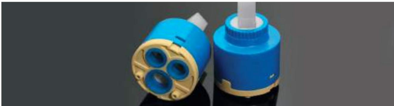
O cartucho cerâmico é a única peça que contém partes móveis do misturador ou torneira. Devido à tecnologia das pastilhas cerâmicas, o desgaste destas partes móveis é tão pequeno que o cartucho dura mais de 12 anos em condições normais de uso. Os cartuchos são testados e aprovados para 600 mil ciclos de abertura e fechamento. As pastilhas cerâmicas são responsáveis pela vedação e garantia contra vazamentos.
